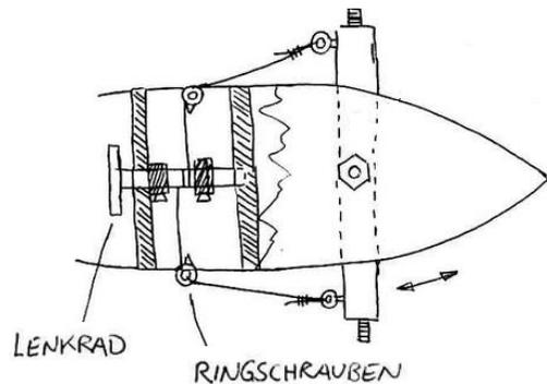
Der Radeinschlag ist so zu begrenzen, dass ein Übersteuern verhindert wird. Für die Lenkung sollten Drahtseile mit min. 3 mm Durchmesser verwendet werden. In der Verlängerung zur Achse müssen die Seile über Seilrollen laufen.
